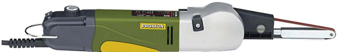
Getriebekopf aus Alu-Druckguss für hohe Stabilität und präzise Kugellager- Passungen. Hauptgehäuse aus glasfaserverstärktem POLYAMID. Balancierter DC-Spezialmotor, durchzugskräftig, leise und langlebig. Stufenlose Drehzahlregelung (Vollwellenelektronik). Schleifarm durch Knopfdruck um bis zu 60° schwenkbar. Absaugstutzen mit Adapter für Staubsauger ermöglicht sauberes Arbeiten. Inklusive 4 Schleifbändern (je 2 Stück K 80 und K 180).
