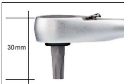
MICRO cliquet à embouts avec logement hexagonal 1/4". Avec insert magnétique. Distance entre le levier du commutateur et l'extrémité de l'embout 30 mm seulement. Avec tête extrêmement mince (23 x 12 mm). Denture fine: plusieurs des 72 dents s'enclenchent simultanément et transmettent un couple élevé. Levier de commutation pour inversion gauche/droite. Forgé en acier CrV, 2x nickelé et chromé mat. Poignée en TPR (Thermoplastic Rubber) résistant à l'huile et aux acides. Longueur totale 120 mm.
