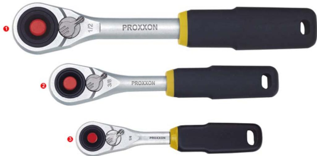
Plusieurs des 72 dents s'engagent simultanément et transmettent un couple élevé. Levier de commutation pour la rotation dans le sens des aiguilles d'une montre et dans le sens inverse. Mécanisme de libération: libérez les embouts en appuyant sur un bouton. Forgé en acier CrV, 2 x nickelé et chromé mat. Manche en TPR (caoutchouc thermoplastique) résistant à l'huile et aux acides. Avec un perçage pratique pour accrocher.
