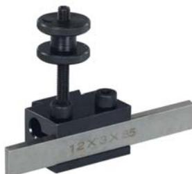
Pour le système de changement rapide PD 250/E. Permet de couper des pièces à longueur et de percer des rainures. Avec lame HSS contenant du cobalt 12 x 3 x 85 mm.
