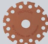
Durch Kühlbohrung geringe Hitzeentwicklung. Anwendungsbereiche: Zum Trennen von Holz (insbesondere Fußböden) und Fugenmörtel. Dicke 1,3 mm.
