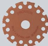
Faible dégagement de chaleur grâce à un orifice de refroidissement. Domaines d'application: Pour tronçonner du bois (des sols en bois en particulier) et des mortiers de jointoiement. Épaisseur 1,3 mm.
