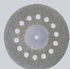
Épaisseur 0,6 mm. Pour le tronçonnage et meulage de porcelaine, de céramique, de panneaux en fibre de verre, de plastique et de métal non-ferreux. Echauffement moindre grâce aux orifices de refroidissement.
